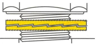
FIGURE 4. NORD-LOCK LOCK WASHER
